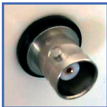
Connettore BNC a baionetta dell'apparato TC RX 434E
